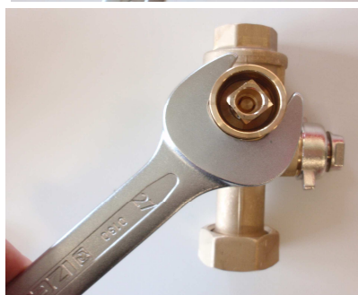
Guľový kohút otvorený Gravitačná brzda nefunkčná (deaktivácia pri preplachu a plnení systému)
