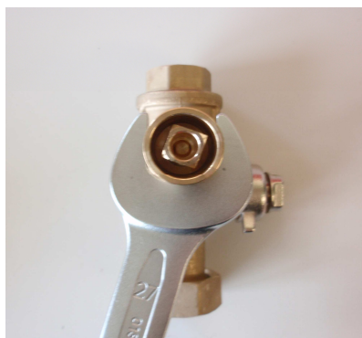
Guľový kohút otvorený Gravitačná brzda funkčná
