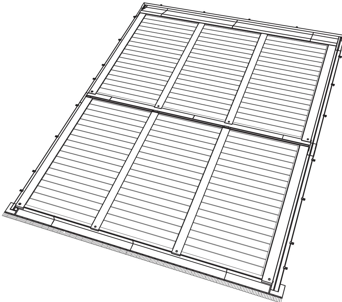
**Einblechung für Dächer ab 27° Neigung! System für Dächer kleiner 27° Neigung a. Anfrage.**
