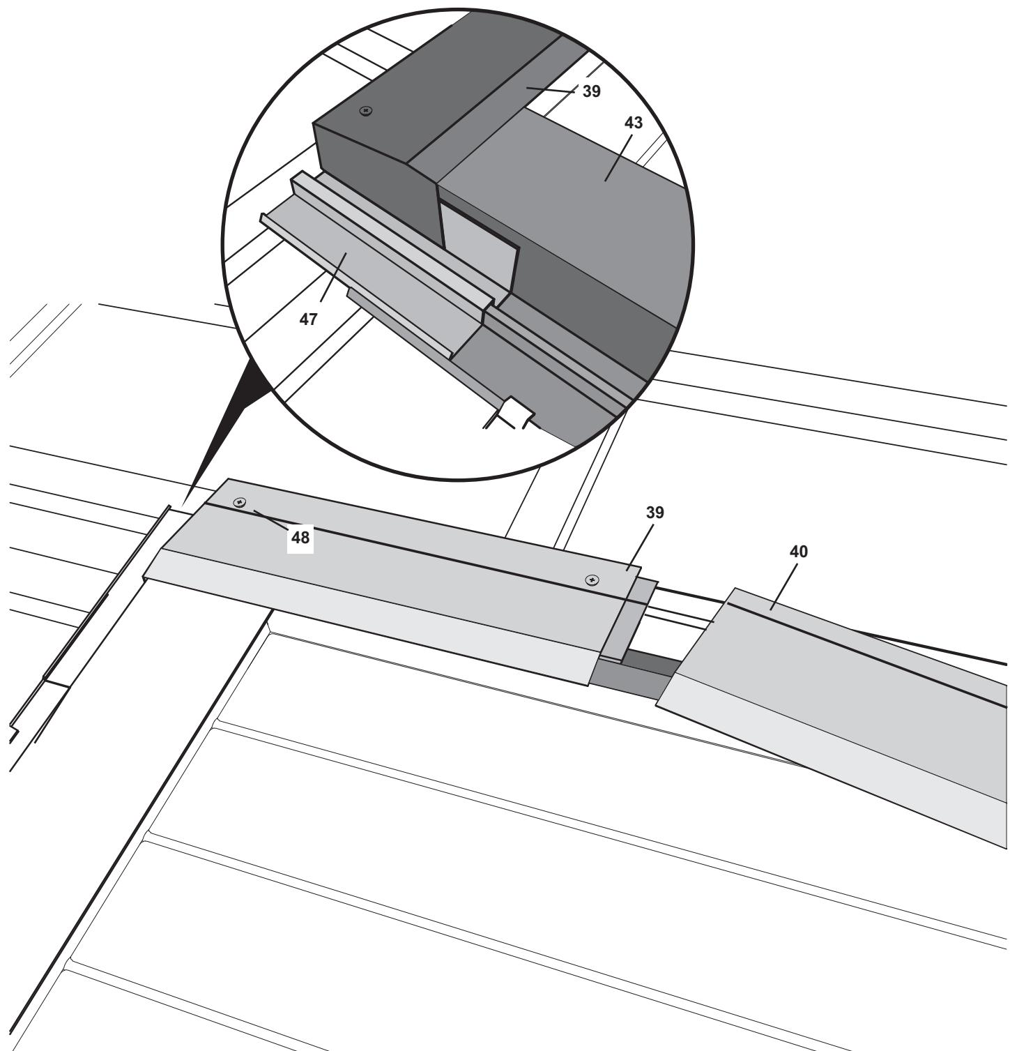
**D Restliche Horizontal-Zwischenabdeckbleche(40/41/42) montieren**
