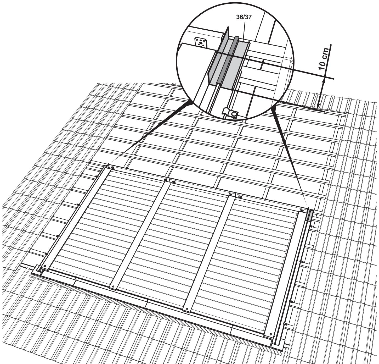
**D Linkes seitliches Horizontal-Abdeckabdeckblech (39) montieren**
